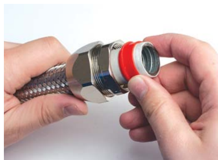
4. Оденьте зажимное уплотнительное кольцо красного цвета на металлорукав. Уплотнительное кольцо одевается стороной с утолщением под зажимную гайку
